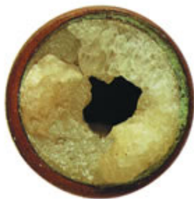
Tubo con muy mal formación de sarro
