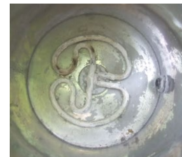
Formación de sarro en un elemento calefactor
